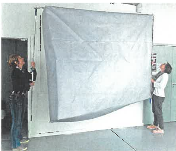
Fig. 3 et 4. Prototypage de bâche ignifugée mis au point par le musée des Beaux-Arts de Dijon : en haut, le dépliage de la bâche ; en bas, le système d'accrochage.
